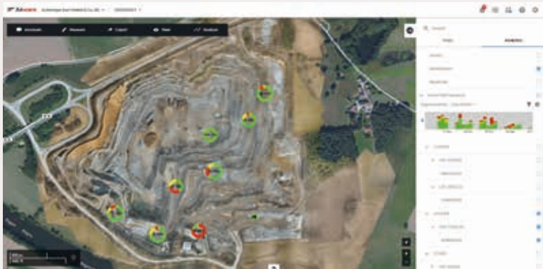
MULDENKIPPER CAT 775: Standortbezogene Verteilung sämtlicher Leerläufe im November 2017 oben. Zoomt man in die jeweiligen Bereiche des Steinbruchs, erscheinen einzelne Leerlauf-Ereignisse.
